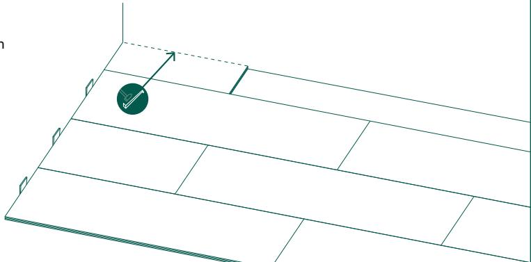
**12.** Realice una plantilla para los encajes alrededor de las tuberías o los objetos irregulares. Coloque la plantilla sobre la lama y márquela. Corte sobre las líneas trazadas empleando un cíter o una sierra y coloque la lama. Alternativamente, puede utilizarse una sierra de corona para cortar las lamas que deban encajar en tuberías.
