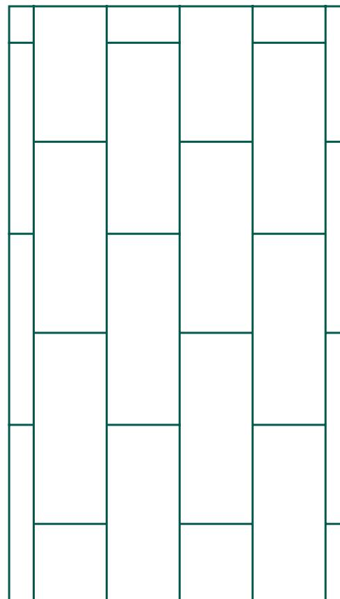
La Baldosa debe instalarse dentro de un patrón de colocación de ladrillos, con las juntas escalonadas.
