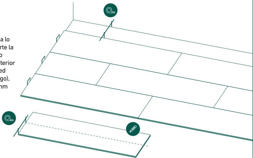
**11.** Instale la lama con el lado cortado siempre mirando hacia la pared. Utilice un escoplo para conectar las uniones. No utilice el escoplo en los bordes cortos. Continue cortando e instalando el resto de las lamas de la última hilera.
