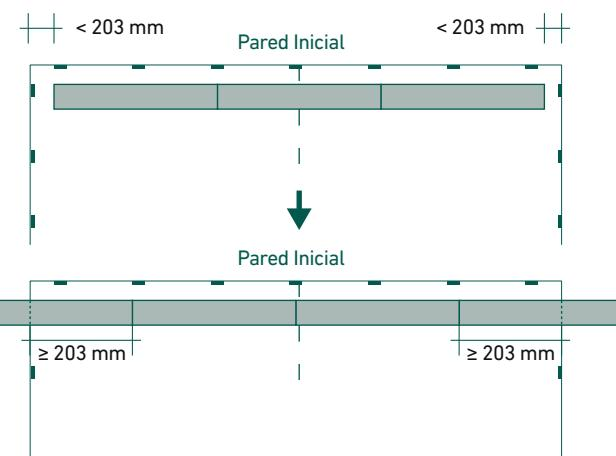
**3.** La instalación debe comenzar en la esquina izquierda y seguir la pared con la lengua hacia la pared. La colocación de la primera lama debe comenzar alejándose de la pared inicial\* (no contra los espaciadores), a una distancia que permita posteriormente la manipulación y replanteo de toda esta primera hilera; en este primer momento, toda la hilera de lamas quedará a esta distancia de la pared y se moverá hacia la misma en un paso posterior (punto 8)
